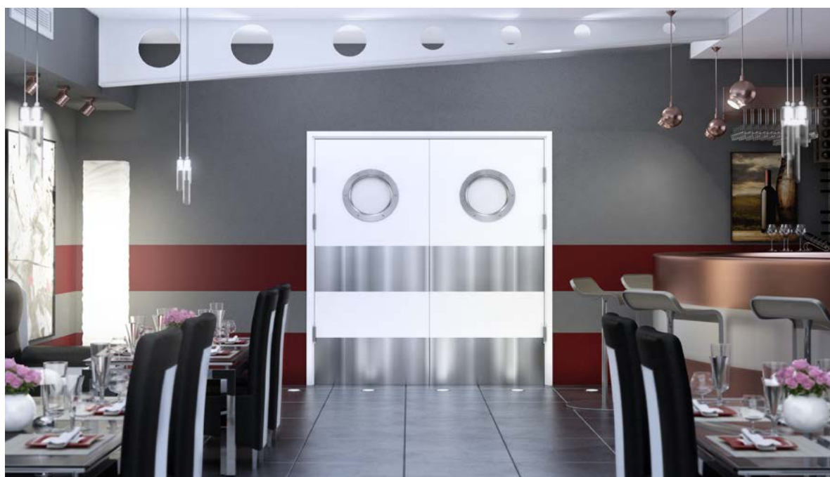
dveře KYVNÉ, VERZE 00, s kulatým okénkem, pevná dřevěná zárubeň
