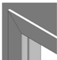
verze B úhel spojení 45° šířka 80 mm bez příplatku
