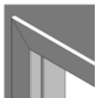
verze A úhel spojení 45° šířka 60 mm bez příplatku
