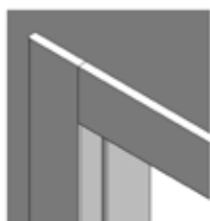
verze C úhel spojení 90° šířka 80 mm
